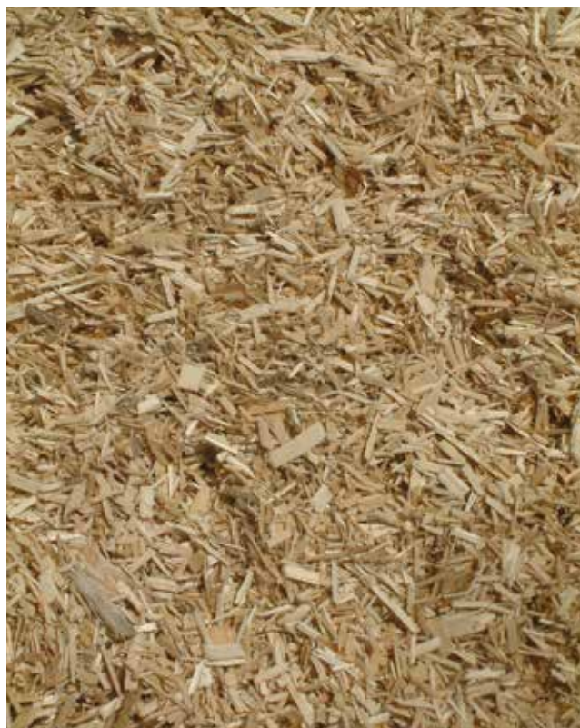
Foto 12.4 - Esempio di cippato ottenuto dagli scarti di lavorazione del pioppo e dalla ramaglia (Foto: PAOLO MORI).
