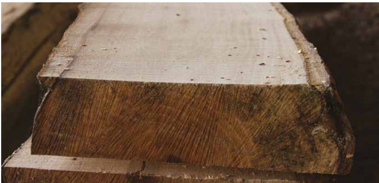
Foto 12.2 - Esempio di tavole di noce non rifilate ottenute tramite segagione (Foto: PAOLO MORI).
